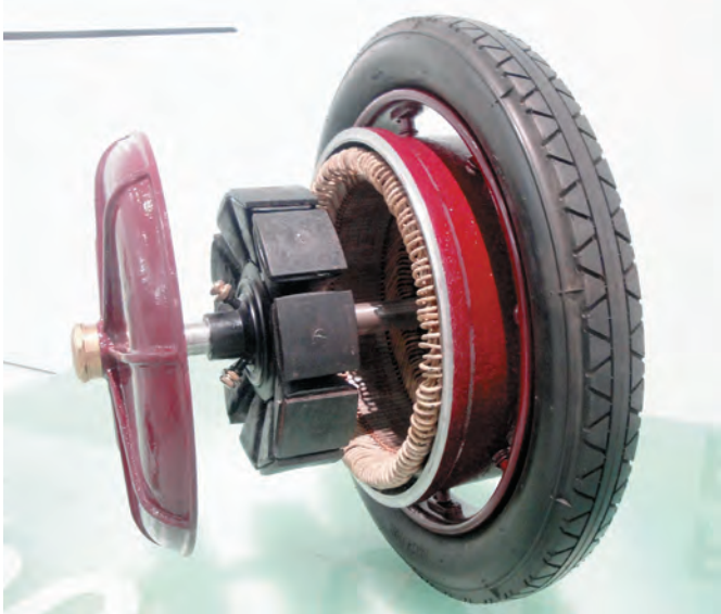
Elektromotor prvega hibridnega vozila, F. Porsche 1896 (Jože Ritonja)
